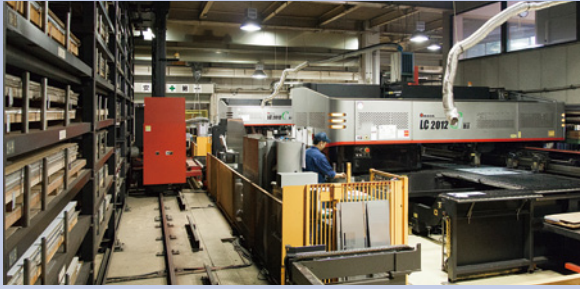
2台のパンチ・レーザ複合マシンLC-2012C 1NTが自動倉庫MARSと連動している
