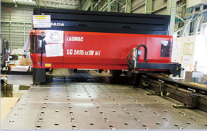
補助テーブルを追加して長さ6mまでの材料加工に対応するレーザーマシンLC-2415aIVNT。シャーリング、Vカット、ベンディングも6mまで対応
