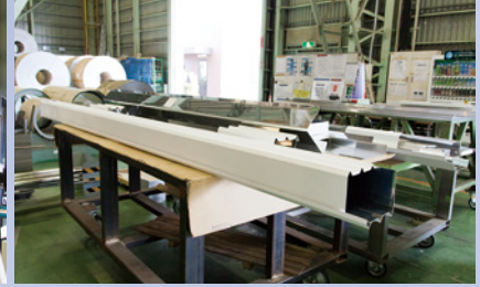
特装車部品(写真)や昇降機部品は長尺の複雑な曲げ加工製品が多く、6m対応の設備力と加工技術が評価されている
