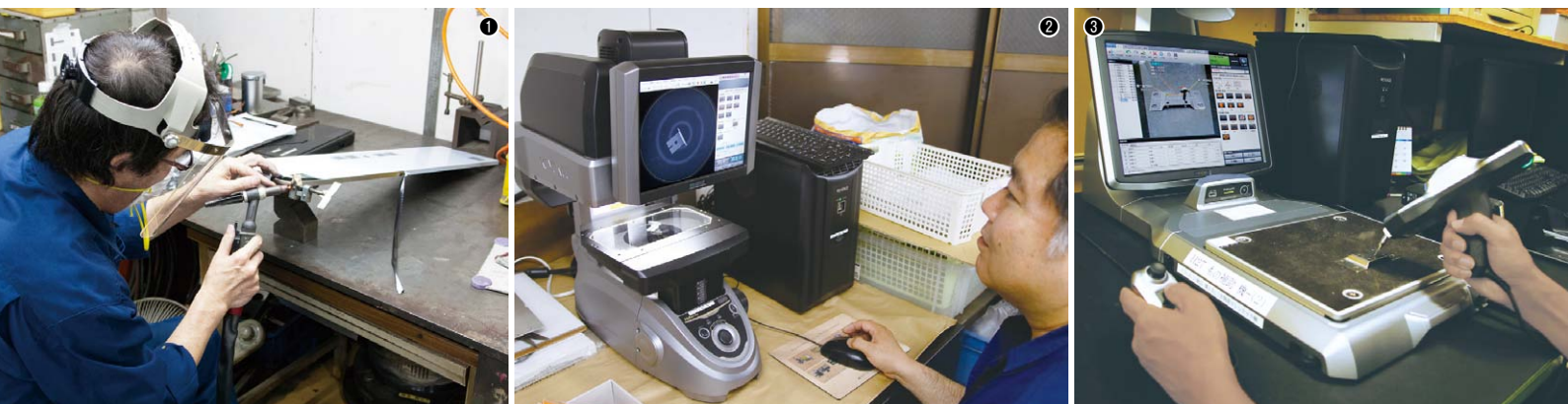
①溶接工程／②画像寸法測定器。測定結果はすべて本体内部に自動保存され、トレーサビリティを確保できる／③ハンディプローブ3次元測定器。簡単な操作で3次元測定ができ、直感的に認識できる
