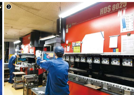
①工程統合マシンLC-2012C1NT+MP-1225NJ×2台は、自動倉庫MARS(5列9段)と連動し24時間稼働している/②ブランク加工後の製品。これまでは合紙を入れていたが、治具をつくって製品を立てることで表面にキズがつかないようにしている/③曲げ工程。ネットワーク対応型ベンディングマシンHDS-8025NT×3台を活用している
