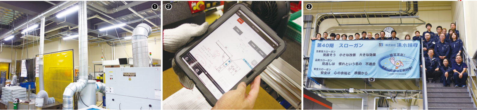
①溶接工程ではスパッタなどを吸引する集塵機を作業台単位に設置して作業環境を改善している／②全社員にタブレット端末が支給され、作業指示や進捗の管理の入力のほか、注記された図面情報の呼び出しもできる／③今期のスローガンに掲げたフラッグと社員たち
